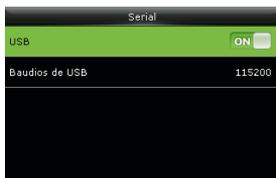
**RS232/USB:** Si desea utilizar la interfaz RS232 o la USB para comunicación, por favor utilice la barra para activar la función.
