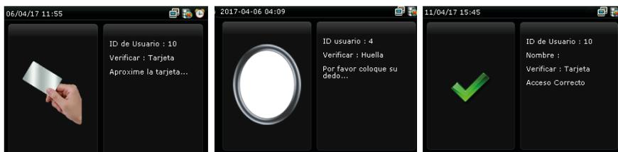
Deslice su tarjeta ID en el lector de tarjetas del dispositivo.
